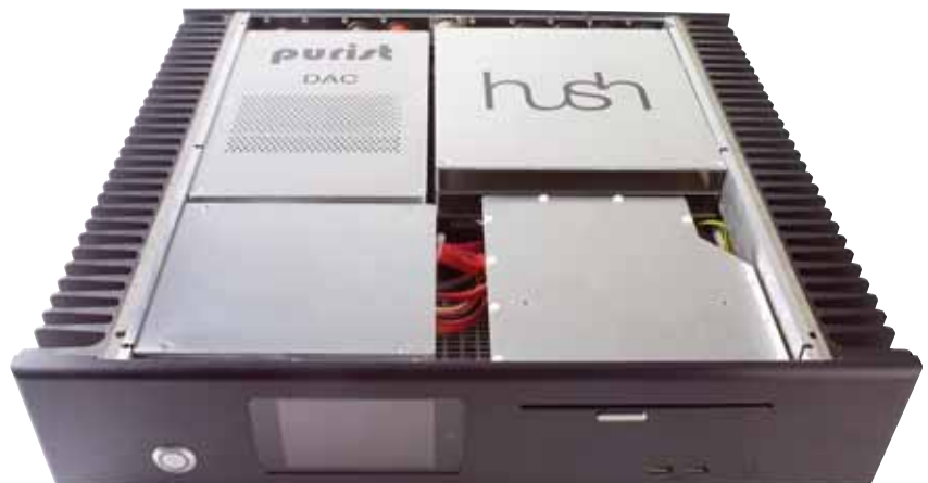
Augenweide: Das ist nicht etwa ein lieblos zusammengestöpselter PC. Der Purist ist auch im Inneren piekfein. Lüfter? Gib't nicht, er ist komplett passiv gekühlt. Außerdem wird er eh nicht heiß
