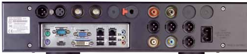
Puristisch? Nix da, wir haben symmetrische Ein- und Ausgänge, Masterclock-in und -out, AES/EBU und tatsächlich sogar ganz normale Cinchausgänge
